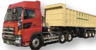
セミトレーラーダンプ最大積載量 24.5t
