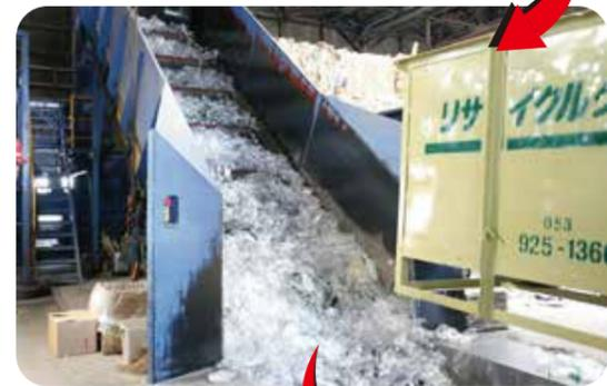
コンテナ4杯分のペットボトルがぎゅっと圧縮され、ひとつの固まりになります。立方体に圧縮することで、トラックに積み込みやすくなりました。10トントラックなら、14個程度が積載可能です。
