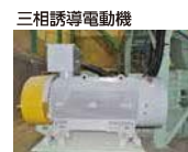
三相誘導電動機 350kwの大型モーター2台で圧縮しながら熱を加えて固めます
