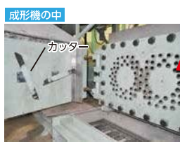
成形機の中 カッター RPFが押し出されながら、スクリーカッターでカットされます。
