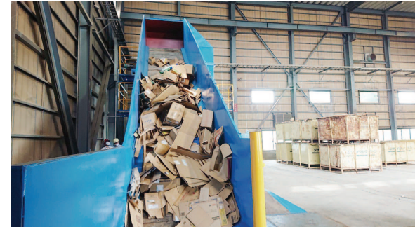
投入された段ボールがベルトコンベアに運ばれていきます
