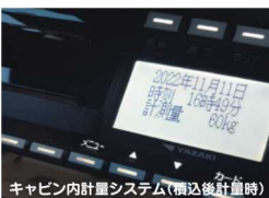
キャビン内計量システム(積込後計量時)
