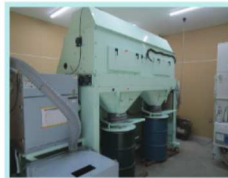
大川工場 密閉式蛍光灯破砕処理機
