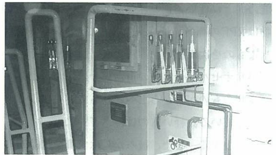
バリオセパレータの機側で傾斜した選別部の覗き窓が見える
