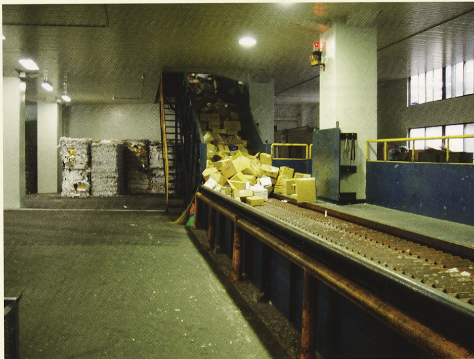
2. 投入コンベアに荷物を載せて、パルパーに荷物を投入します。
