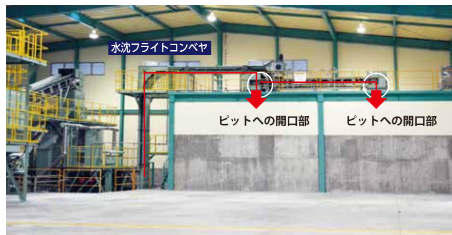
工場内部で作られたRPFは開口からトラック等に積載が容易な外部ピットに落とされます。
