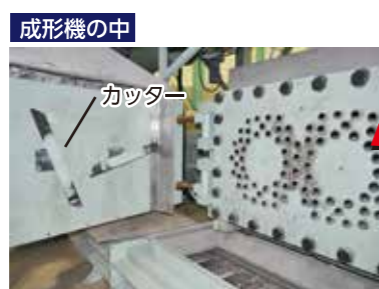
RPFが押し出されながら、スクリーカッターでカットされます。
