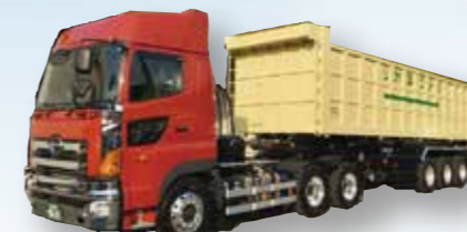
セミトレーラーダンプ最大積載量 24.5t
