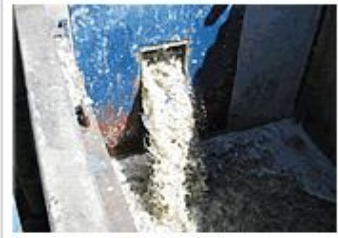
残渣・サーマルリサイクル後 鉄→製鋼原料へ 灰→セメント原料へ
