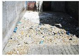
残渣・サーマルリサイクル後 鉄→製鋼原料へ 灰→セメント原料へ
