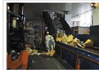
コンベア投入→特殊パルパーで溶解
